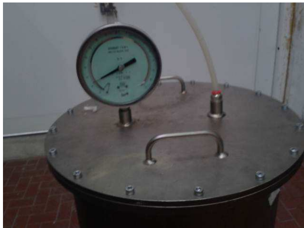
Verifica del grado IP X8 / IP X8 degree test
