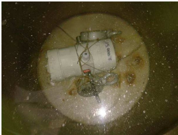
Verifica del grado IP X8 / IP X8 degree test
